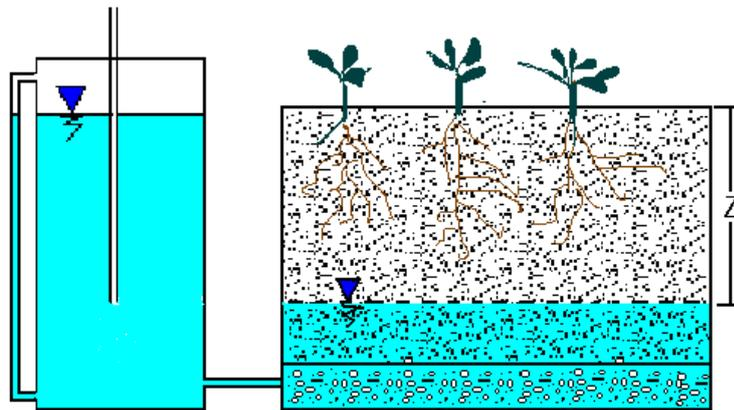
Figura 5: Representación esquemática de un lisímetro<sup>1</sup> en el que se simula la presencia de un nivel freático abastecido con una botella de Mariotte. Referencia: Tafur, H., Ríos, L. *Aplicaciones prácticas del principio del frasco o botella de Mariotte*. Disponible en:
