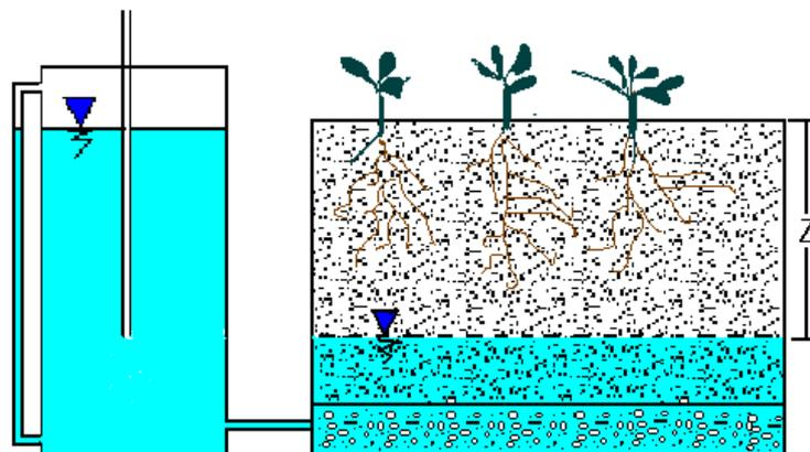
Figura 5: Representación esquemática de un lisímetro<sup>4</sup> en el que se simula la presencia de un nivel freático abastecido con una botella de Mariotte. Referencia: Tafur, H., Ríos, L. *Aplicaciones prácticas del principio del frasco o botella de Mariotte*. Disponible en:
