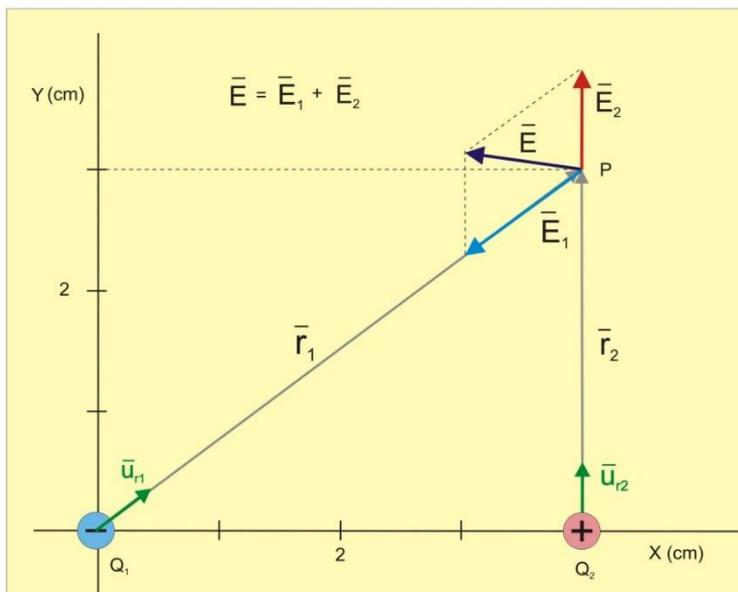
En la figura se han dibujado los vectores  $\vec{E}_1$  y  $\vec{E}_2$  (no a escala) y se ha determinado gráficamente el vector  $\vec{E}$  como suma de los anteriores. Para obtener analíticamente el vector  $\vec{E}$ , debemos expresar primero  $\vec{E}_1$  y  $\vec{E}_2$  en función de sus componentes cartesianas y luego sumarlos.
