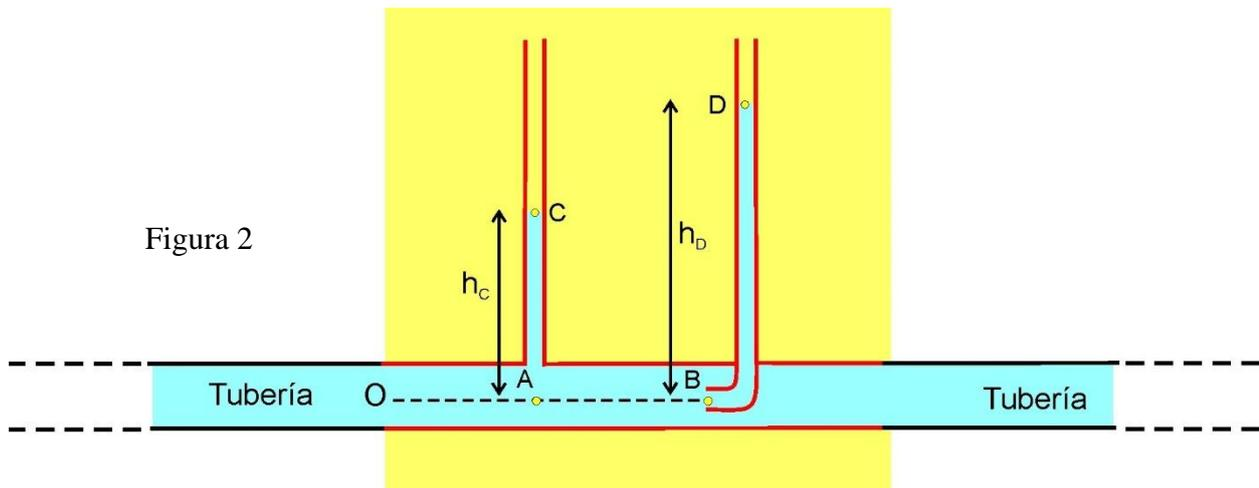
El agua al circular asciende por los tubos verticales hasta alcanzar en ellos una altura tal que la presión de la columna de agua en su base impide que entre más agua, alcanzándose así una situación de equilibrio en la que la velocidad del agua en el punto B será nula y la velocidad del agua en el punto A, será la velocidad que queremos calcular.
