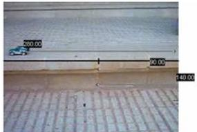
Después de comprobar en los experimentos con sensores que el movimiento del cochecito de cuerda puede ser uniforme, elaboramos otro diseño experimental para estudiarlo y simularlo. Se filmó el movimiento del cochecito con una cámara digital sencilla y se incorporó la grabación a una animación *Modellus* preparada para simular un movimiento uniforme. Se obtuvo un buen grado de concordancia entre el movimiento real (filmado) y el movimiento teórico simulado.
