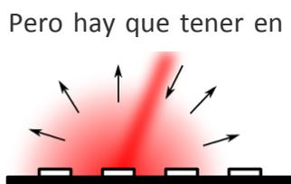
Pero hay que tener en cuenta que el tamaño de las ranuras es muy pequeño y comparable con la longitud de onda de la luz que incide sobre ella. Por tanto, la luz ya no se refleja en los espejos siguiendo las leyes de la óptica geométrica, sino que cada uno dispersa luz en todas las direcciones de un plano vertical, tal como indica el dibujo adjunto.
