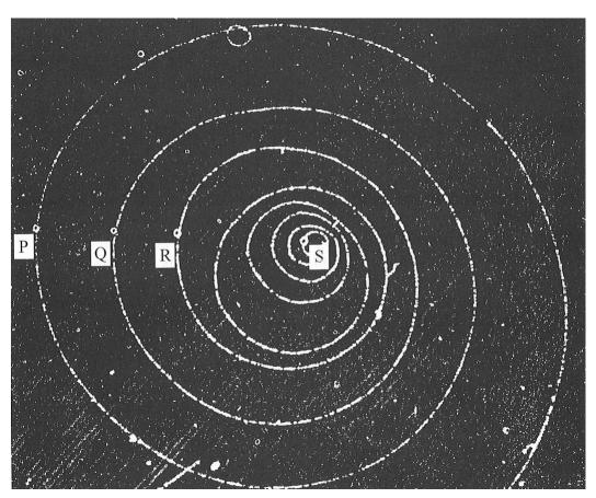
**4.** El diagrama simplificado adjunto muestra las "des" de un ciclotrón conectado a una corriente alterna de alta frecuencia (aplica una tensión de *12kV*). La línea de puntos representa la trayectoria de un protón. El campo magnético en las "des" es de *0.8T*, perpendicular a la hoja.
