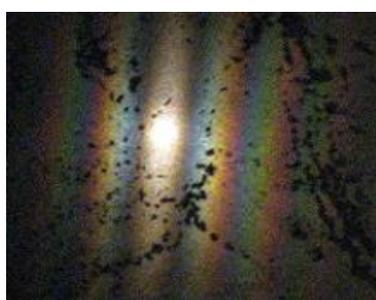
Para ver las interferencias producidas en este experimento se puede usar una linterna y hay que colocarse a una distancia suficiente del espejo (del orden de un metro o dos), procurando que el ojo y la fuente de luz estén lo más próximas entre sí que sea posible y en la dirección perpendicular al espejo. También se
