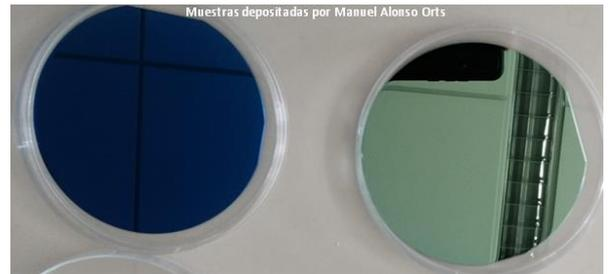
Sus espectros de reflectividad (debajo) constatan que cada una de ellas tiene su pico interferencia constructiva en las longitudes de onda indicada por la tabla anterior, pero, sin embargo, para nuestros ojos la **lámina violeta** (óxido de aluminio) se ve de color **azul oscuro**. Ello se debe, por una parte, a
