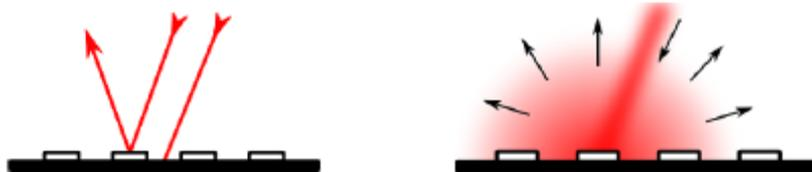
Estas ondas de luz, que emergen de los "micro-espejos", producen fenómenos de interferencia, porque la luz reflejada por cada uno interfiere con la reflejada por los demás (en fase producen
