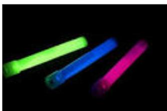
En una pequeña cápsula de cristal dentro de cada barrita se tiene peróxido de hidrógeno (agua oxigenada), rodeado de otro líquido, que está formado por un éster de fenil oxalato mezclado con tinte del color deseado. Todo ello está envuelto por un plástico resistente pero flexible. Cuando se dobla la barrita, la cápsula se rompe y todos los componentes se mezclan dando lugar a una reacción química que genera una luz brillante e intensa.
