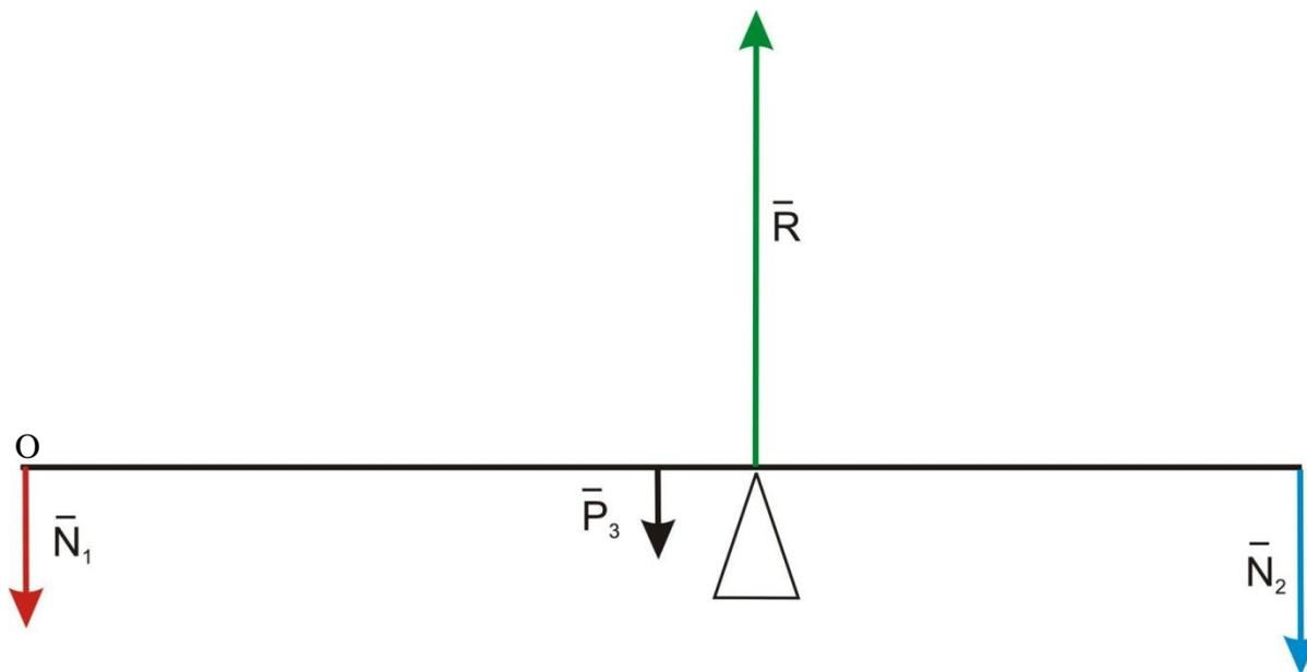
En la figura anterior  $\vec{N}_1$  es la pareja (acción-reacción) de  $\vec{R}_1$  y  $\vec{N}_2$  lo es de  $\vec{R}_2$  (por lo que  $N_1 = R_1$  y  $N_2 = R_2$ ).  $\vec{P}_3$  es el peso de la barra y  $\vec{R}$  la fuerza que el apoyo ejerce sobre la barra.
