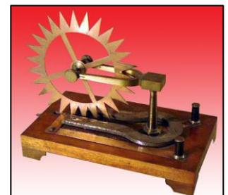
Otro pionero en el campo de los motores eléctricos fue el científico Ányos István Jedlik (1800-1895) que desarrolló el primer motor electromagnético formado por un estator, un rotor y un conmutador. Usó luego este diseño para propulsar por primera vez un vehículo y el original de su prototipo que sigue funcionando hoy en día (se encuentra en el Museo de Artes Aplicadas de Budapest).
