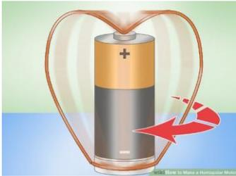
El término *homo* proviene del hecho de que el campo magnético mantiene siempre la misma polaridad. Son motores de corriente continua que no tienen grandes aplicaciones en la actualidad, porque resultan ineficientes, aunque pueden usarse para diseñar máquinas rotativas (turbinas, ruedas, banas transportadoras...). El más sencillo de estos motores para desarrollar en el aula se esquematiza en la figura adjunta.
