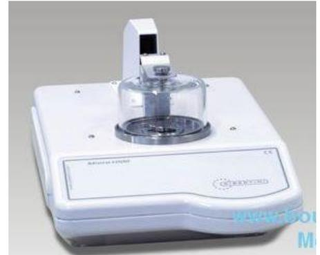
En los equipos más actuales un sistema de posicionamiento óptico detecta el desplazamiento e informa al sistema de control de alta precisión, pudiendo entonces reajustar el equilibrio y conocer así el peso. Con estas balanzas se alcanzan resoluciones de hasta 0.001 mg.
