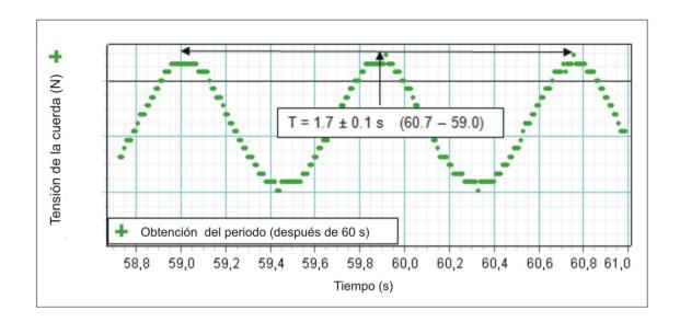
Estos mismos resultados, se pueden obtener con mayor precisión realizando con el programa un ajuste sinusoidal en las gráficas, ya que dicho ajuste proporciona los tres parámetros básicos de la oscilación registrada por el sensor (amplitud, periodo y fase). Usando este procedimiento, hay que tener en cuenta que el periodo de la oscilación en la tensión de la cuerda (que es lo que mide el sensor) es exactamente igual a la mitad del periodo de una oscilación completa del péndulo simple.
