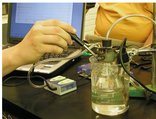
Fig. 5. Montaje experimental para estudiar la segunda ley de Gay-Lussac [2].
