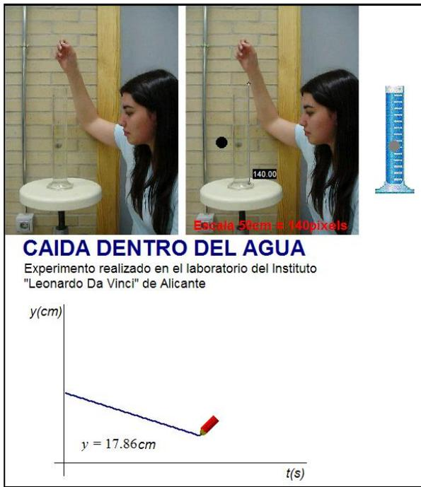
FIGURA 7. Animación para analizar la caída de una bola de plástico dentro del agua.
