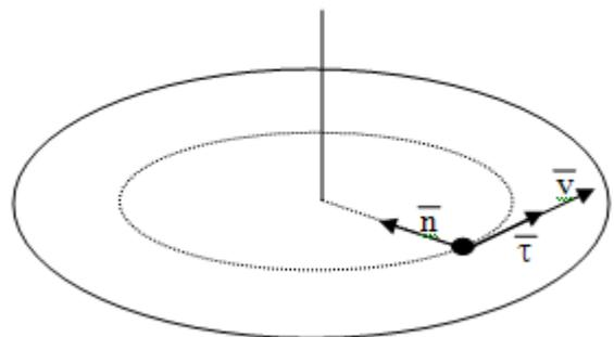
Dicha fuerza, en la situación descrita, solo puede ser la fuerza de rozamiento, que se opone al deslizamiento del cuerpo sobre el disco, ya que el resto de fuerzas que se ejercen sobre el cuerpo (concretamente el peso y la reacción del plano) son perpendiculares a la plataforma.
