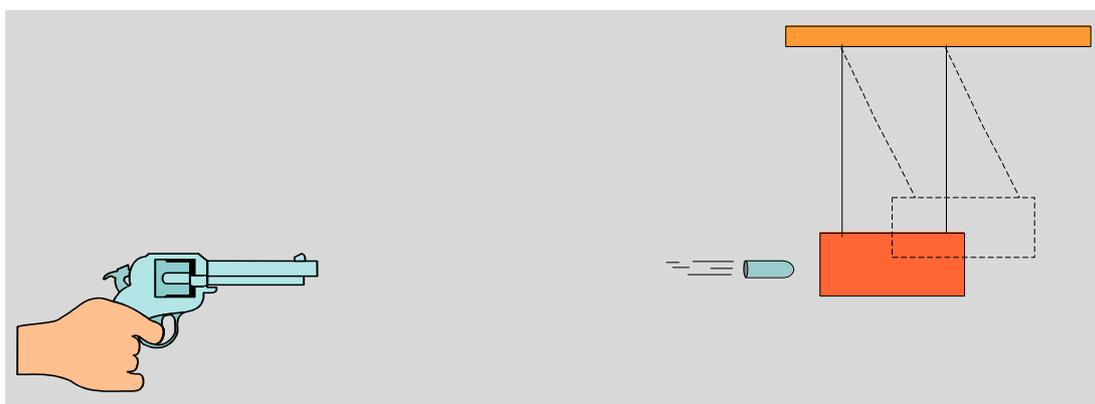
La bala realiza un choque directo contra el bloque con una velocidad  $\vec{v}_1$  quedando empotrada en él (choque perfectamente inelástico). A consecuencia del choque, el conjunto formado por la bala y el bloque oscila ascendiendo hasta alcanzar una cierta altura  $h$  respecto al nivel inicial.
